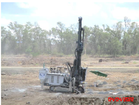
รูปที่ 2-4 เครื่องเจาะระเบิดที่มีอุปกรณ์เก็บฝุ่นติดไว้ที่หัวเจาะ
